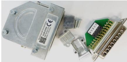
Die Stiftausführung SUB-D25M-VATSeries613 wurde speziell für das Butterfly Stellventil der Serie 613 von VAT konzipiert. Der große Vorteil an der Ausführung liegt darin, dass eine einfache Konfektionierung durch die Federzugklemmen gegeben ist und diese unter Feldbedingungen stattfinden kann. Zusätzlich bietet das robuste Metallgehäuse die Möglichkeit, den Kabelschirm großflächig aufzulegen und gewährleistet so eine hohe Abschirmung gegen EMV-Störeinflüsse.
